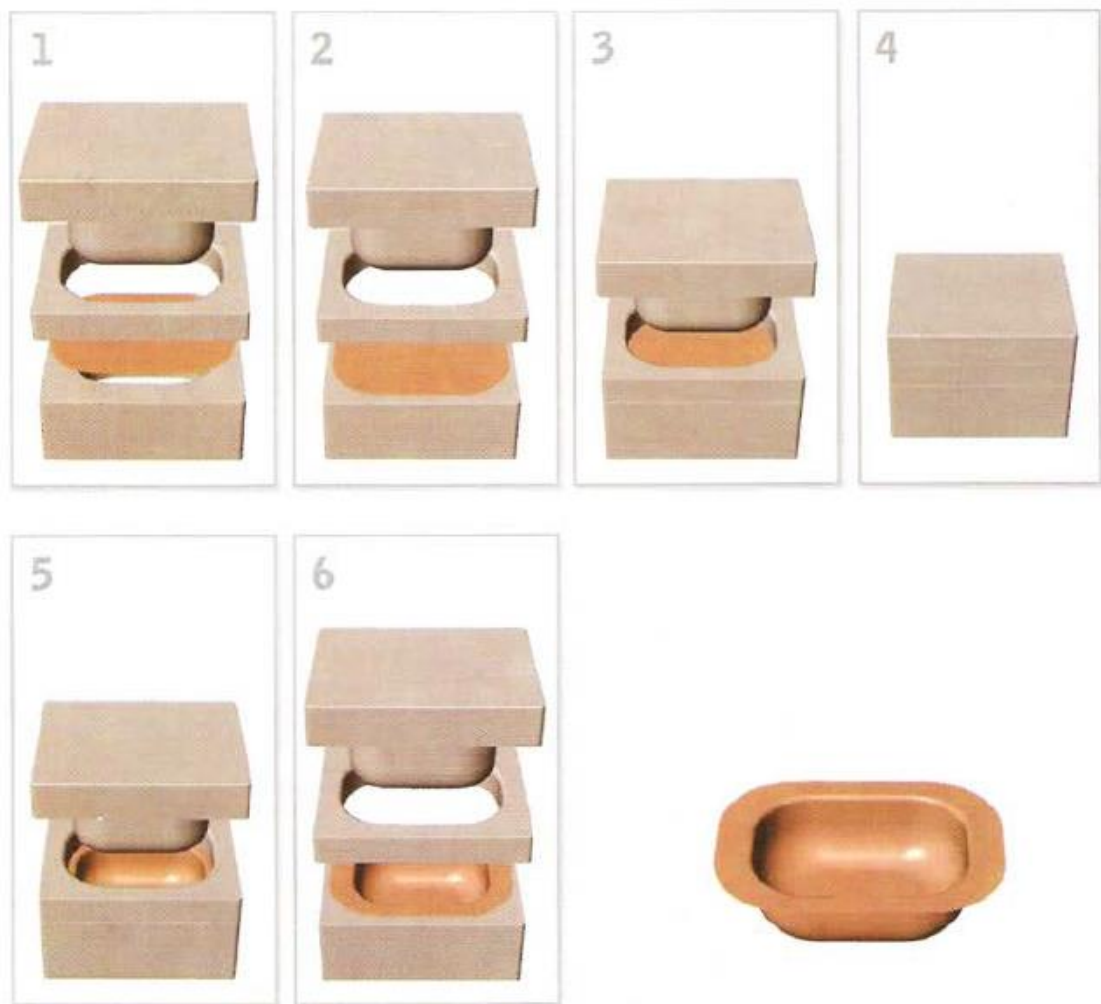
Figura 13 – Sequência de passos da conformação de chapas.
