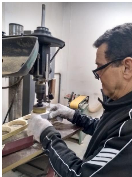
Figura 63 – Corte das circunferências dos braceletes com a serra copo.
