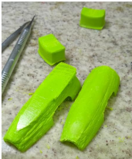
Figura 51 – Retirada do excesso.
