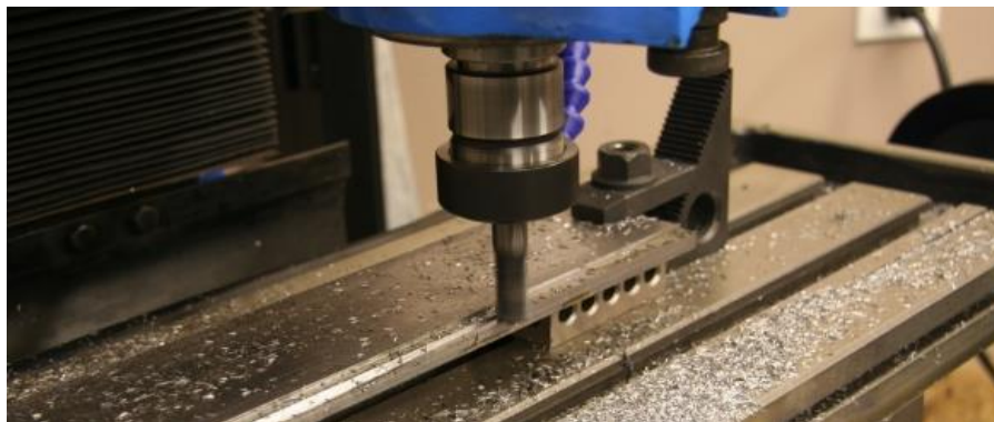
Figura 12 - Máquina de fresar usinando uma chapa metálica.
