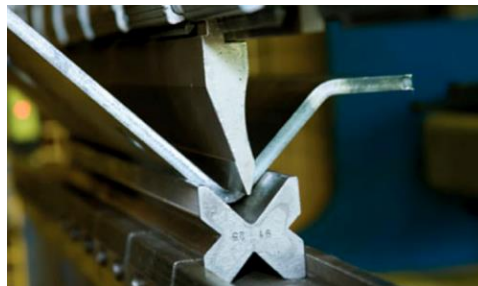
Figura 7 – Perfil de máquina de dobrar chapas feita em aço a frio.
