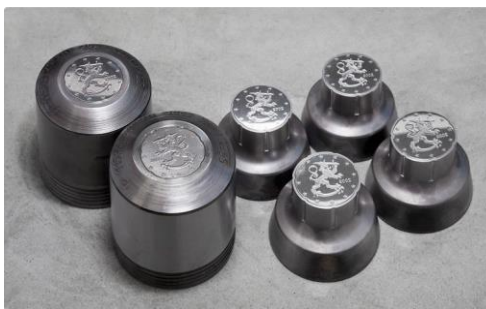
Figura 8 – Cunhagem feita em aço temperável em água.
