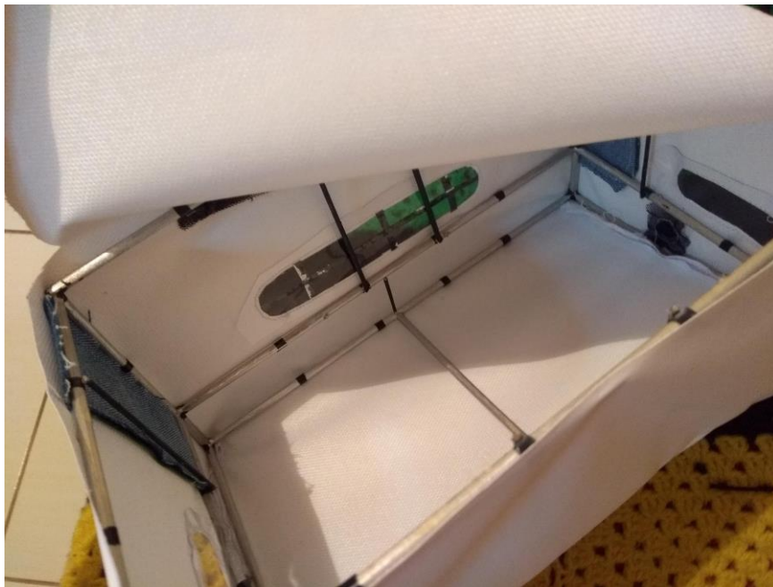
Figura 43 Fixação da lona na estrutura.
