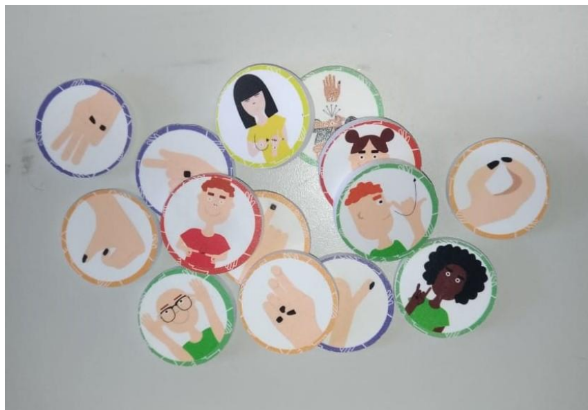
Figura 42: Peças encaixáveis produzidas com impressão UV e corte em máquina CNC.
