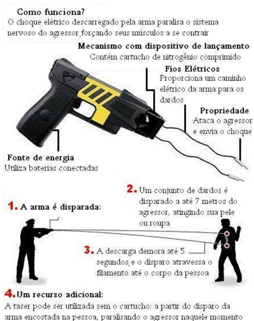
Figura 38 - Funcionamento da arma Taser.
