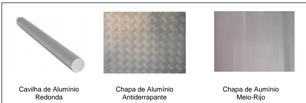
Quadro 3 - Tipos de Alumínio encontrados na indústria
