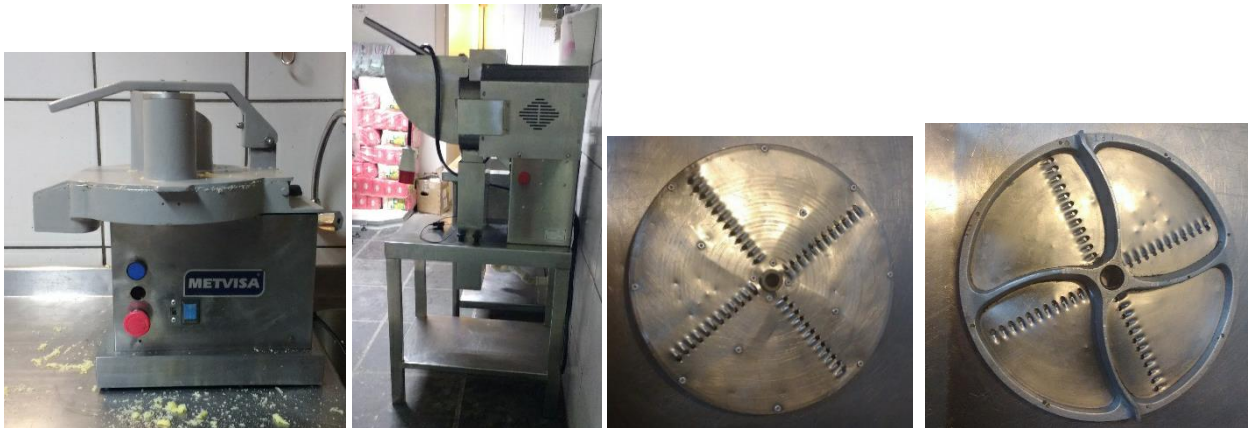
Figura 3: Ralador de queijo industrial (esquerda). Lâmina utiliza das para ralar o queijo (direita), parte de cima e parte de baixo, respectivamente.
