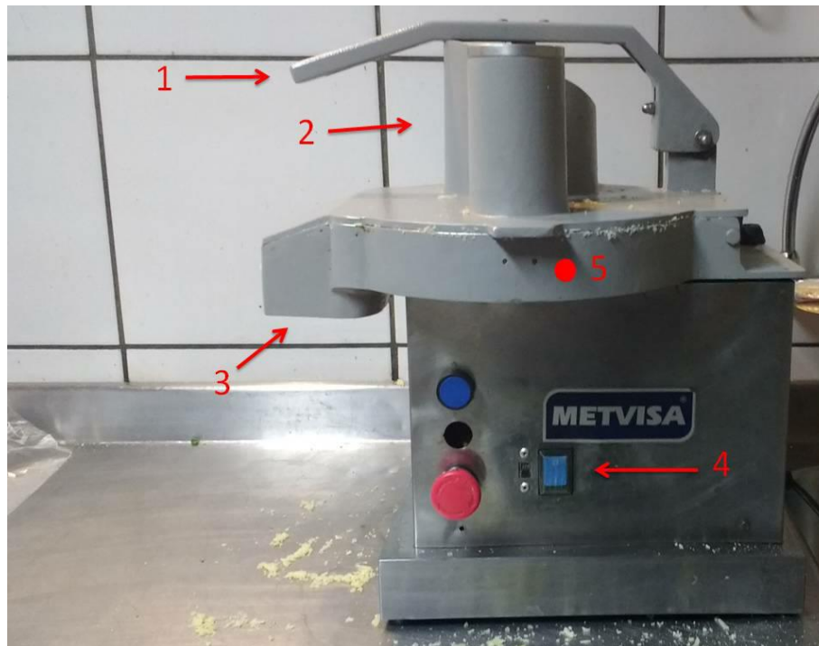
Figura 23: Equipamento industrial utilizado para o corte de queijo. Fonte: Acervo da autora (2016).
