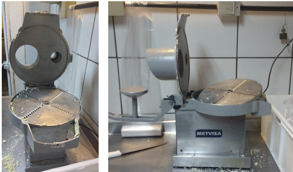
Figura 26: Parte interna da máquina, local onde a lâmina é depositada (esquerda); Lâmina desencaixada para limpeza (direita).
