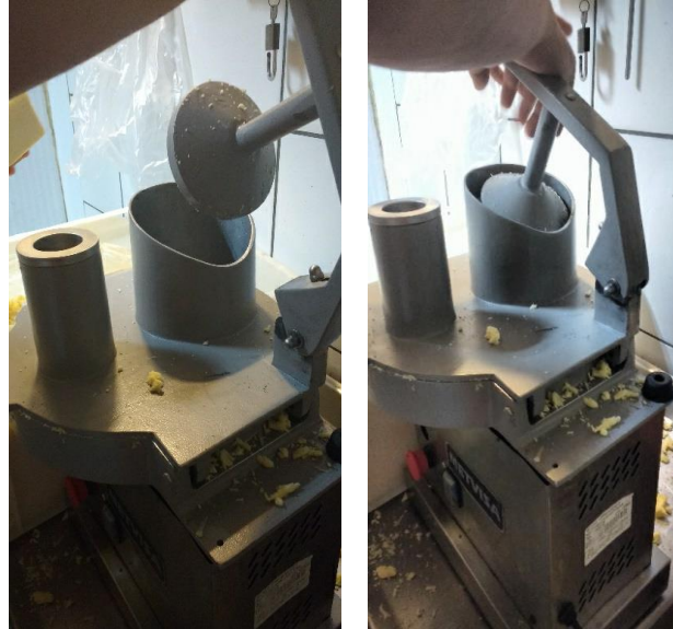
Figura 24: Funcionário levantando a alavanca para o depósito do alimento (direita); Usuário pressionando a alavanca para baixo para ralar o queijo (esquerda).
