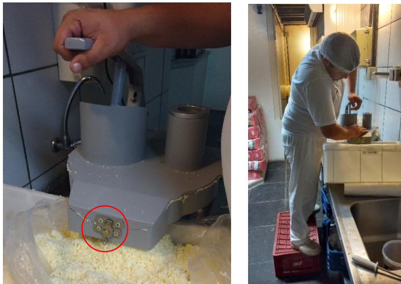
Figura 25: O produto, após o processo realizado, fica depositado em uma caixa para posterior pesagem (esquerda); Postura do colaborador utilizando a máquina (direita).
