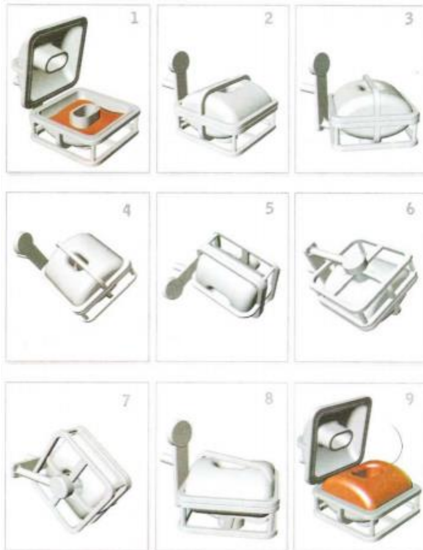
Figura 18: Processo de Rotomoldagem. Fonte: LIMA (2006, p.204).
