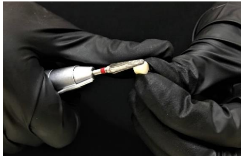
Figura 6: Desgaste inicial com fresa de tungstênio
