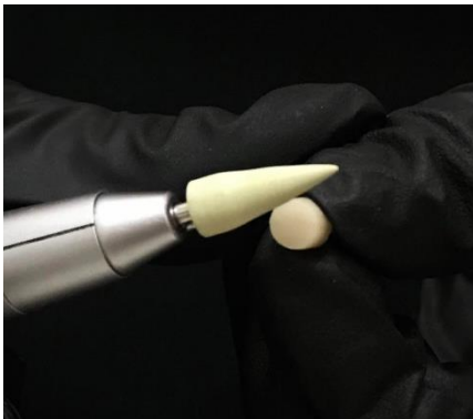
Figura 11: Acabamento e polimento com borracha abrasiva fina
