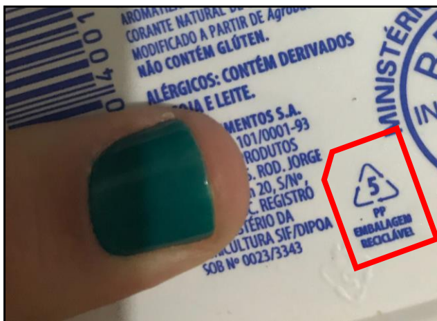
Figura 16 - Identificação do polipropileno em um pote
