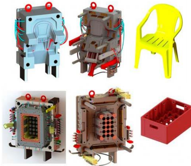
Figura 18 - Moldes para injeção de termoplásticos
