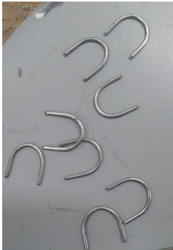
Figura 54 – Corte dos arcos passa fio.
