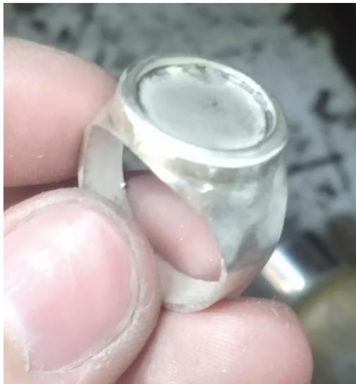
Figura 64 – Anel com o fundo soldado.
