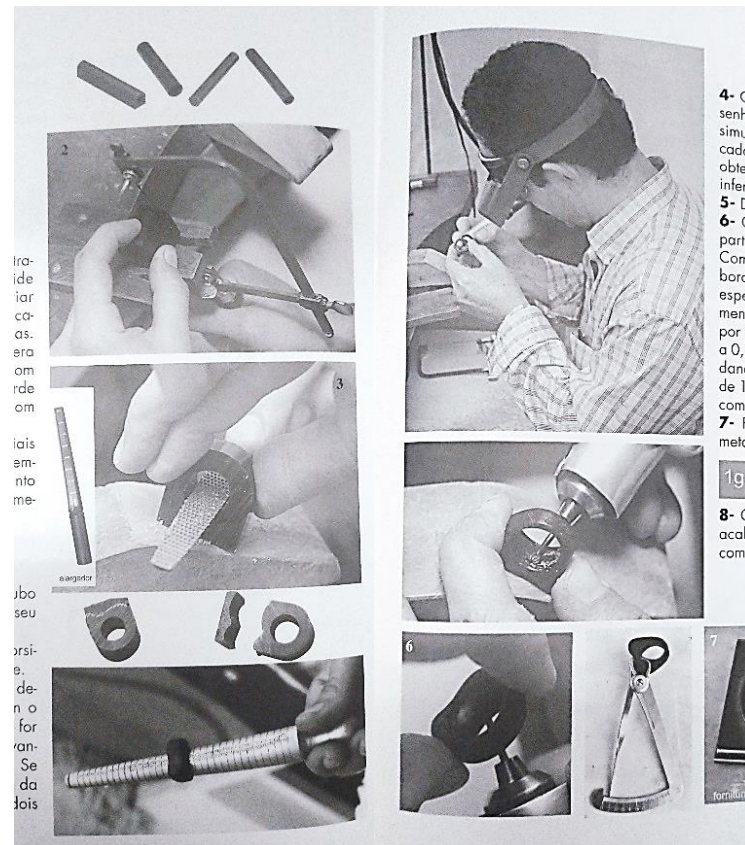
Figura 25 e 26 - Processo de produção de anel em cera.
