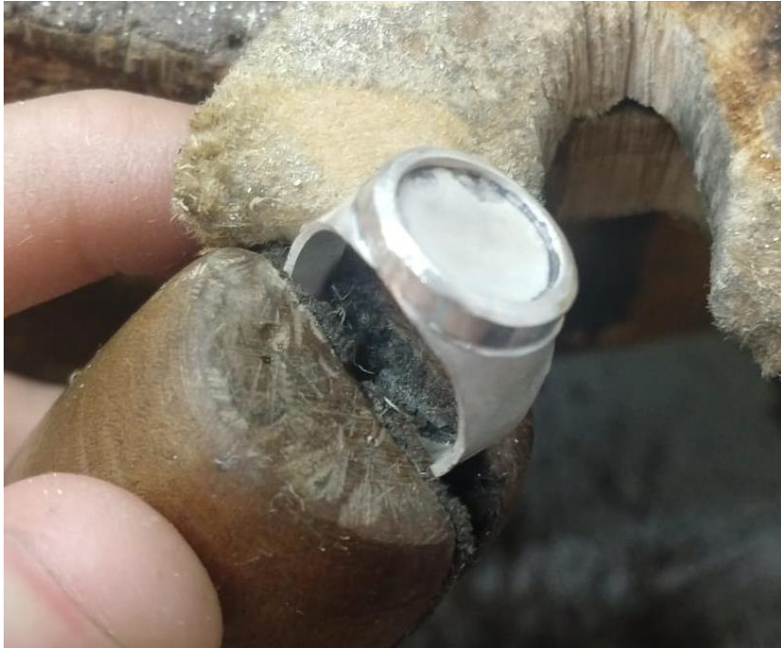
Figura 65 – Processo de acabamento com limas.
