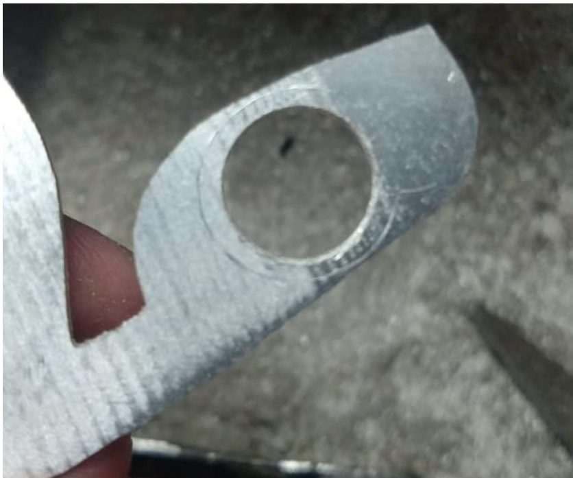
Figura 62 – Recortando fundo da parte de cima do anel.
