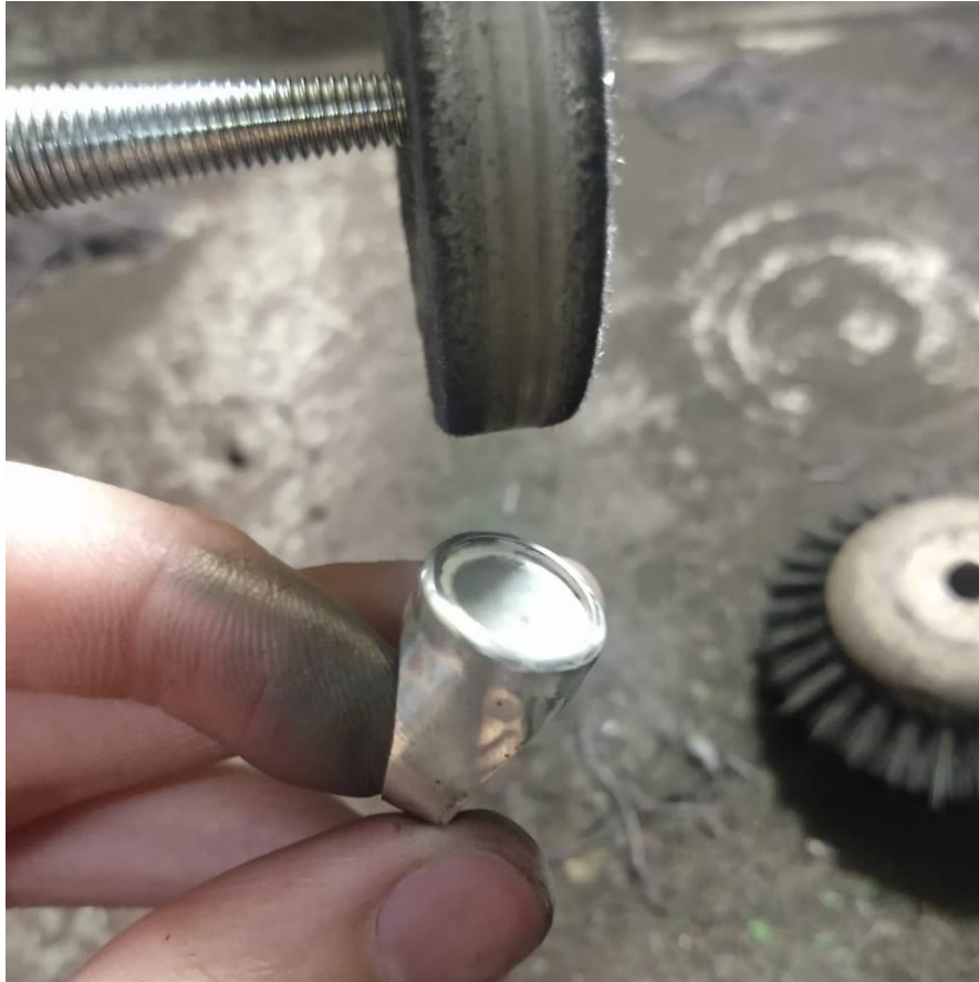
Figura 67 – Acabamento de polimento na politriz.
