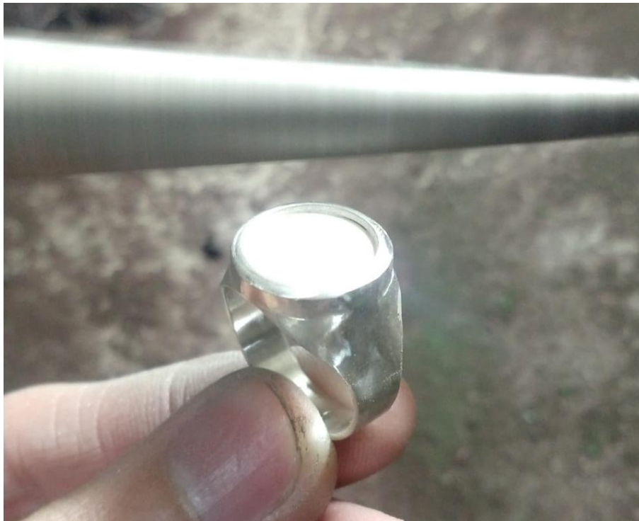
Figura 66 – Processo de acabamento com lixas.
