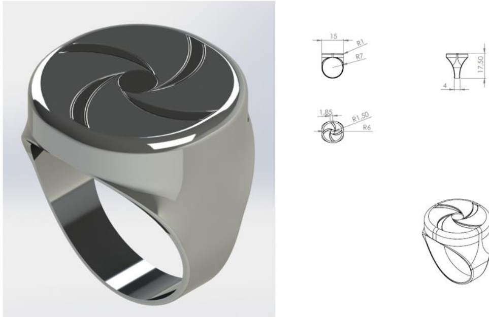
Figura 47 - Imagem e medidas do Anel Roda de moto para melhor visualização.
