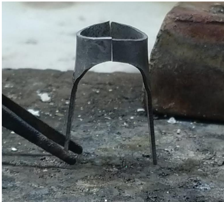
Figura 58 – Formas do anel dobradas para a soldagem.
