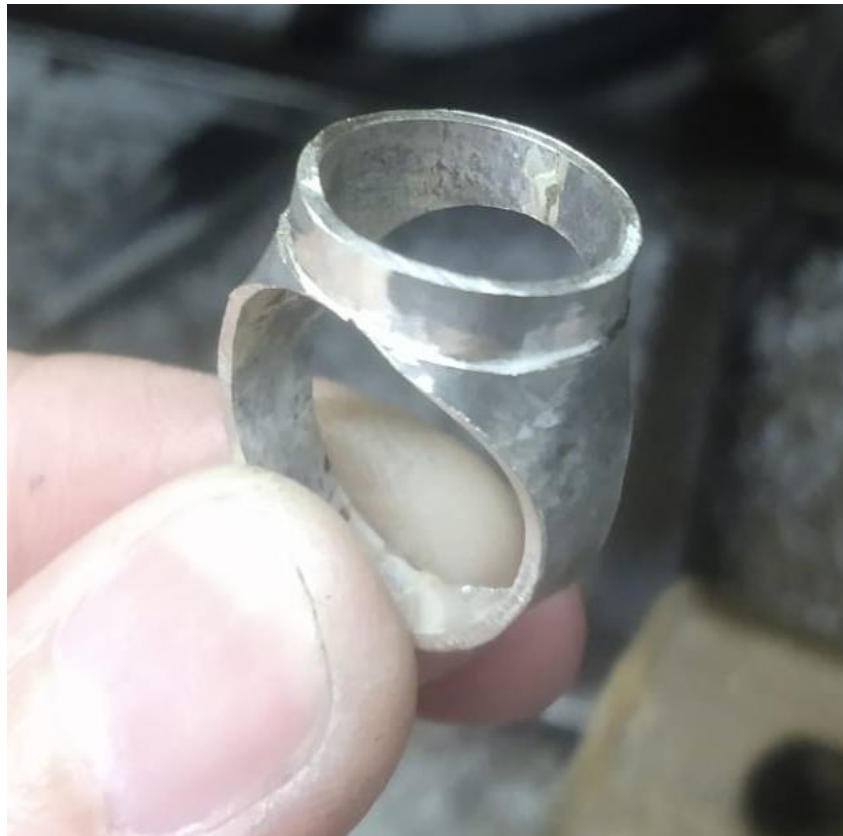
Figura 60 – Base do anel soldada sem o fundo.
