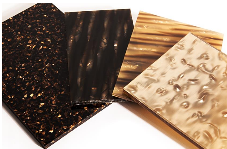
Figura 27: exemplos de chapas de acetato usadas para a fabricação de óculos.
