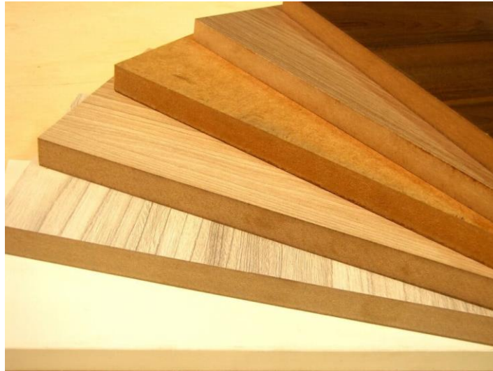
Figura 10 – MDF com revestimento melamínico.
