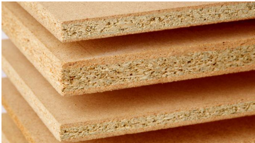
Figura 11 – Chapas de MDP sem revestimento.
