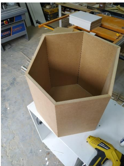
Figuras 62 e 63 – Parte, nomeada como caixa, montada, ainda sem acabamento.
