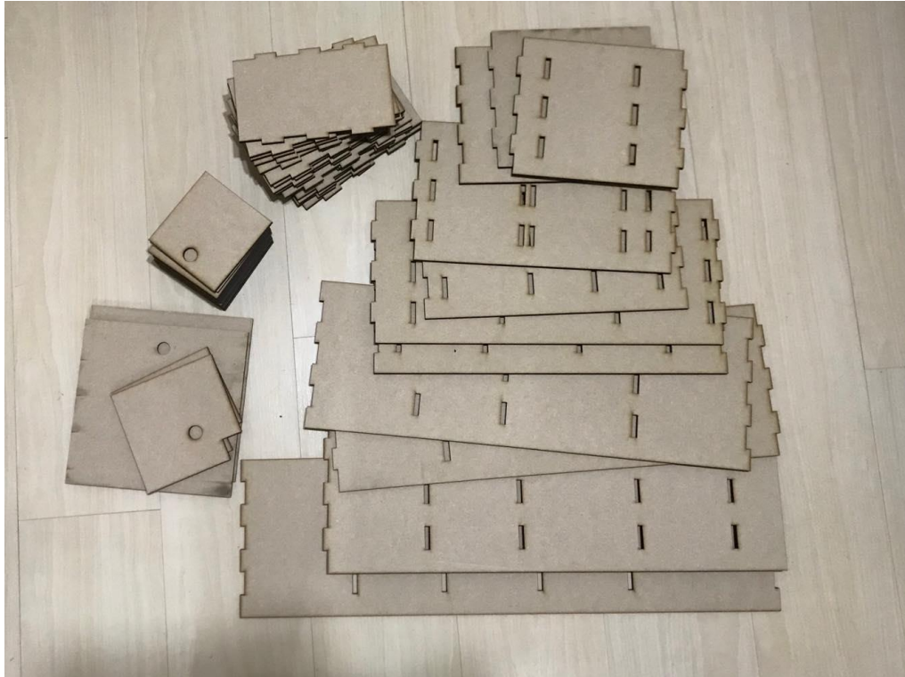
Figura 65 – Estrutura da estante desmontada.
