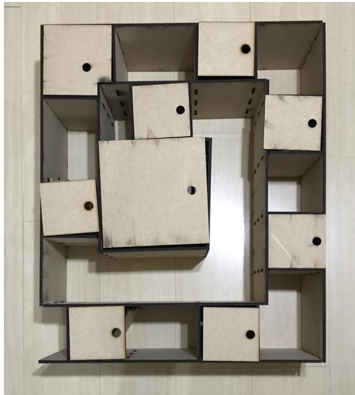
Figura 66 – Estrutura da estante somente encaixada
