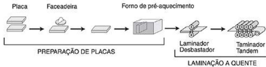
Figura 14 – Processo do laminador a quente.
