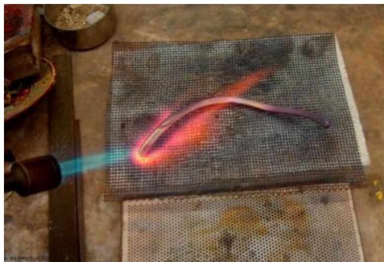
Figura 18: Recozimento da prata no processo de produção da joia.
