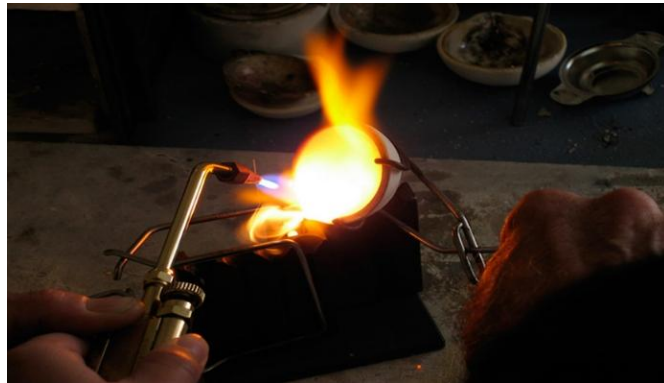
Figura 17: Processo de fundição das ligas metálicas.
