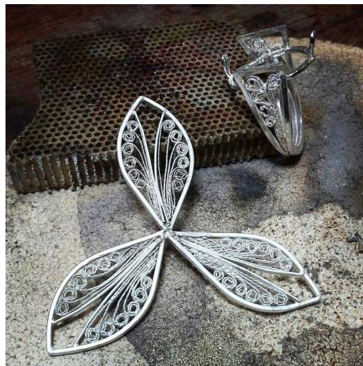
Figura 2: Técnica de filigrana, processo de joalheria artesanal.
